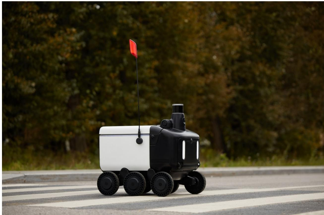
Роботы четвертого поколения — первые, которые будут выпускаться серийно. Их производство проще, а себестоимость ниже, чем у предшественников — при этом они более функциональны. На одном заряде новые роботы могут преодолеть до 70 км. Они оснащены съемной батареей, а грузовой отсек можно разделить и доставлять два заказа за один рейс.
